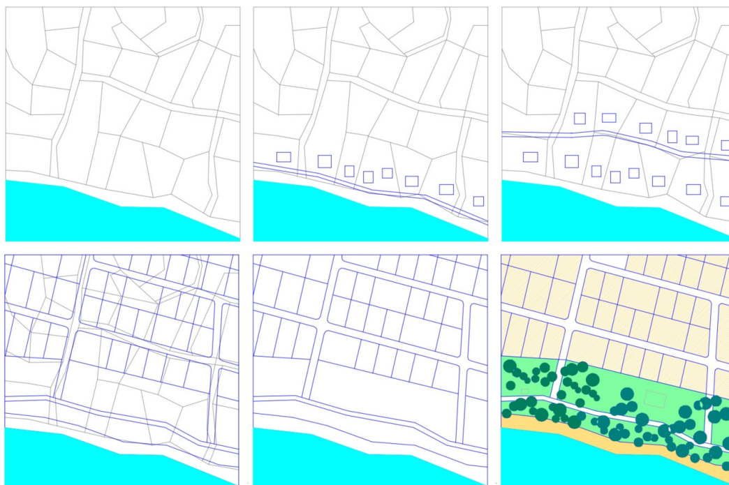
Slika 8. Shematski prikaz primjene preparcelacije za dobivanje obalnog odmaka (Prilagođeno prema JICA)
